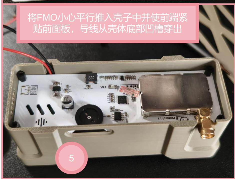
将随壳附带的导线按照如图所示的方向及颜色用**铜柱**将其固定。（红色对应5V、黑色对应GND，**严禁反接，反接必烧！！！**）
